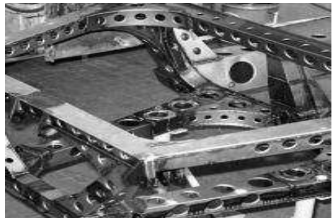
Fig.8 TP400のシャシーに空けられた無数の軽減孔
