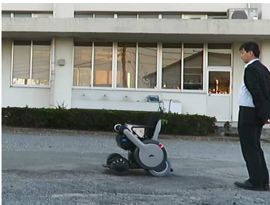
図 6. 衛星測位を用いた自動運転試験
