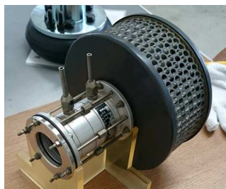
Fig. 13 Laminar flow meter (Sokken LFE-400LM)
