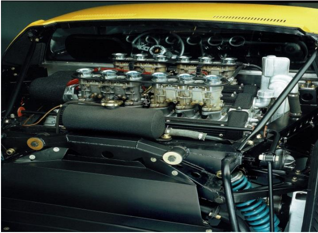
Fig.29 ランボルギーニ・ミウラ P400 の V12 横置きエンジン
