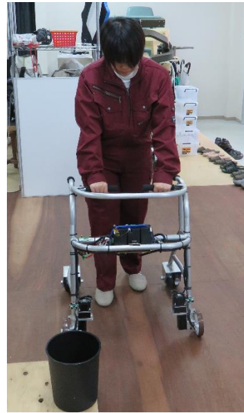
図10 障害物検知のテスト
