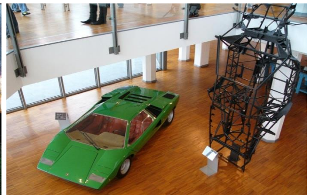
Fig.76 ムゼオの入り口に飾ってあるカウンタックのベア・シャシー
