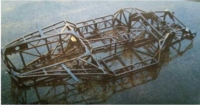
Fig.65 ランボルギーニ・カウンタックのマルチチューブラーフレーム
