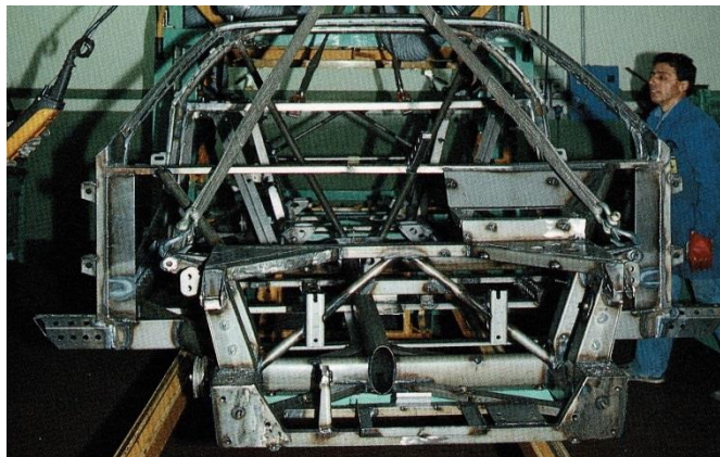
Fig.55 フェラーリの床部に伸びる極太の楕円断面鋼管とラダーフレーム
