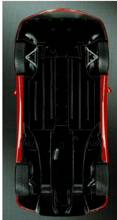
Fig.186 360 モデナのアンダーフロア
