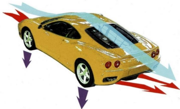
Fig.181 360 モデナの空力とダウンフォースの流れ
