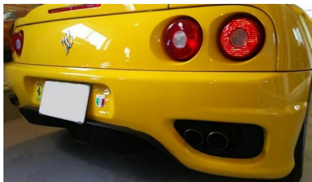
Fig.95 360 モデナのリヤのエアアウトレットダクト
