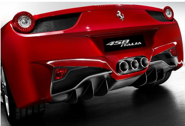
Fig.223 フェラーリ 458 イタリアのディヒューザー
