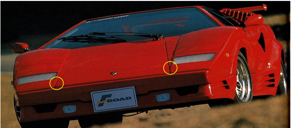
Fig.243 カウンタックの左右のキャラクターラインとボンネットラインの接地点の不一致
