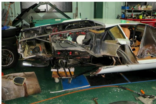
Fig.305 衝突事故で右リヤを損壊したカウンタック LP400S
