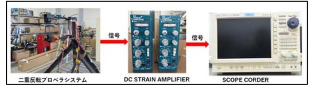
Fig. 2 二重反転プロペラ推力測る実験の模型
