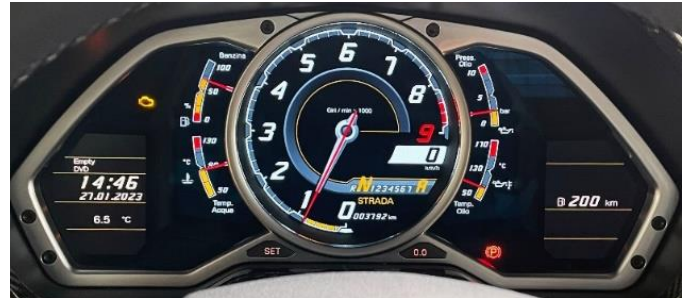
ランボルギーニ・アヴェンタドールのメーターパネル
