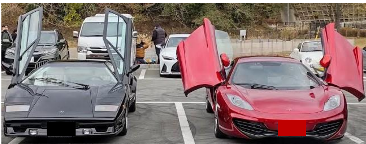
垂直に開くカウンタックのシザーズ・ドアと、斜め上に開くマクラーレン車のディヘドラル・ドア
