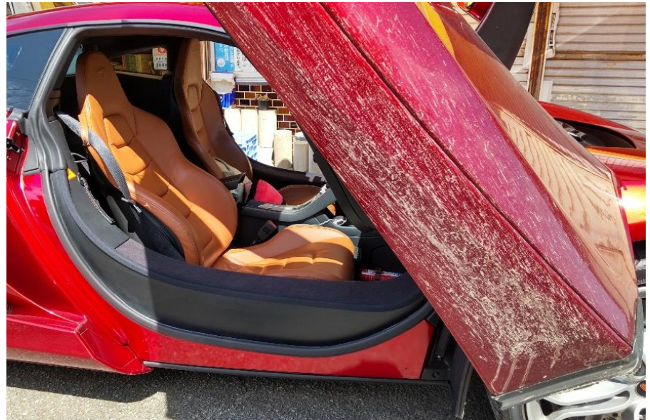
マクラーレン車のディヘドラル・ドアと後方に向かって高くなるサイドシル
