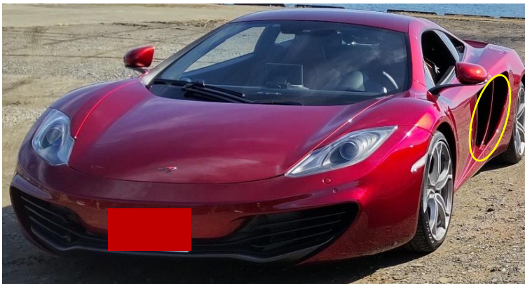
MP4-12C のサイドに設けられた巨大なエアインタークとフィン
