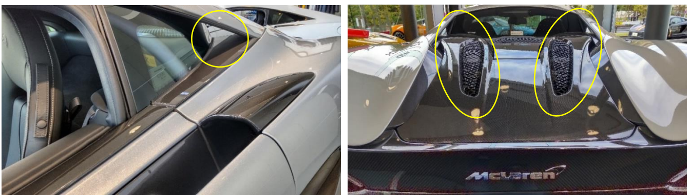
マクラーレン 540C のフライングバットレスの空気腔と、そこからエンジン排熱へと空気を導くエンジンフード上のデザイン
