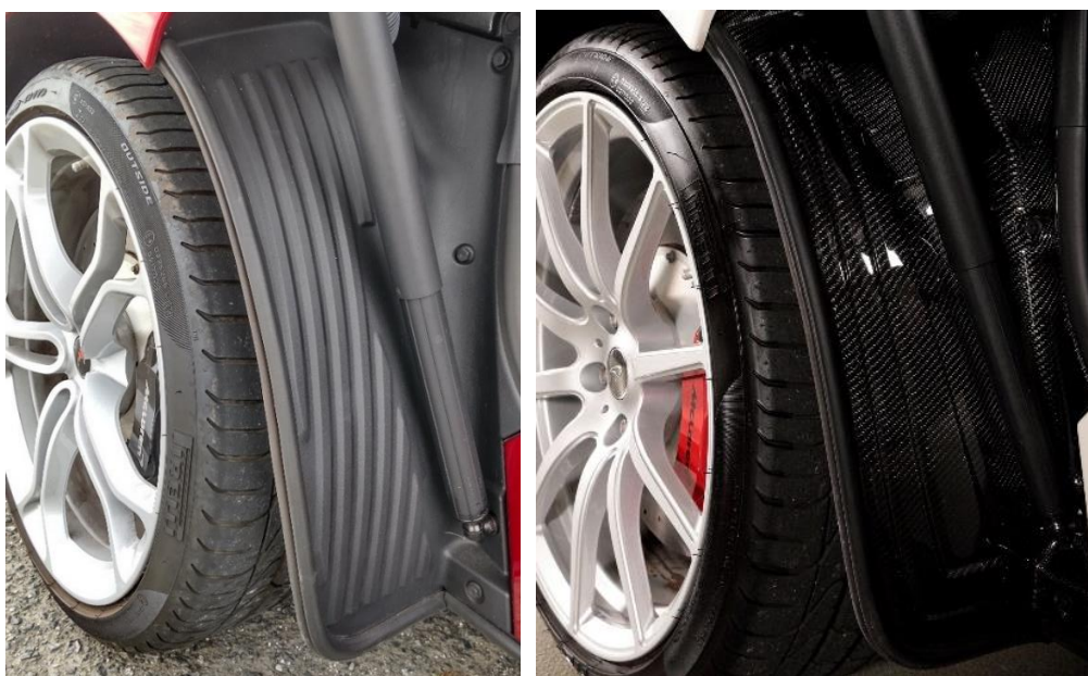
MP4-12Cのノーマルの樹脂製フロントホイールアーチと、オプションのカーボンファイバー製フロントホイールアーチ
