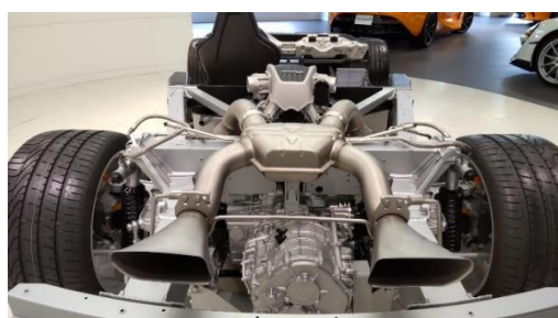
上方排気のマフラーとシート後方中央に設けられた燃料タンク(○が燃料タンク)
