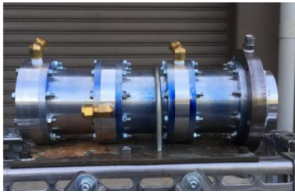
図6 実際に製作された多段面 旋回流・後方逆旋回流方式 エンジン
